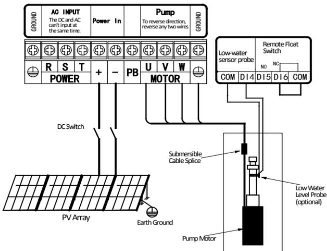
Figure10System Wiring Diagram
