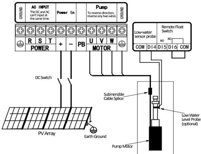
Figure10System Wiring Diagram
